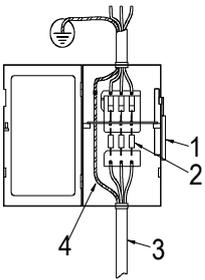
Рис 6.1 Подсоединение блока подключения
