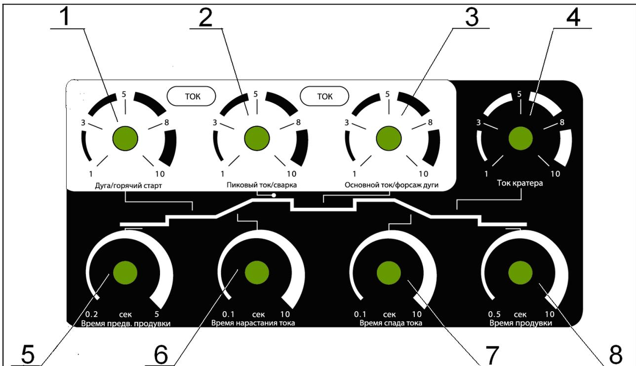
**Рисунок 5.5 Зона контроля сварочных параметров**
