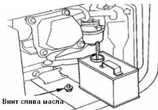
2. Выкрутите масляный щуп, и открутите винт маслосливной горловины, и дождитесь полного слива масла. Закрутите винт маслосливной горловины и заправьте двигатель новым маслом до верхнего предела. Закрутите масляный щуп.
