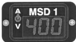
Для монтажа прибора MSD1 снимите заглушку с передней панели установки. Подключите штеккер ленточного кабеля, расположенный под заглушкой, к соответствующий разъем MSD1. Переключателем прибора выбирается показание либо напряжения либо тока. На
