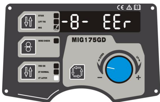
Рис 14: Сбой подачи проволоки
