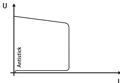
**Устройство Antistick предотвращает прокаливание электрода.**
