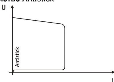
Устройство Antistick предотвращает прокаливание электрода.
