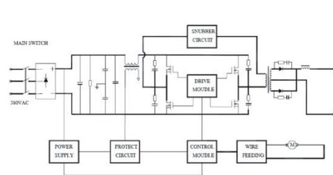
Источник питания и механизм подачи выполнены в отдельном исполнении и соединены при помощи соединительного кабеля, состоящего из сварочного кабеля, газового шланга и кабеля управления. Сварочная горелка подключается посредством евроразъема, расположенного на передней панели механизма подачи.
