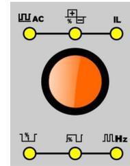
11. **ЧАСТОТА АС (только в режиме АС):** дополнительно позволяет регулировать частоту переменного тока
