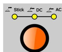
**AC:** для аргонодуговой сварки на переменном токе (алюминиевые сплавы, металлы с загрязненной поверхностью /трудноудаляемым оксидом)
