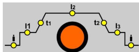
3. **ПРОДУВКА НАЧ.** : чтобы гарантировать чистоту сварного шва, газ (argon) подается перед зажиганием дуги; этот переключатель предназначен для регулировки времени задержки.
