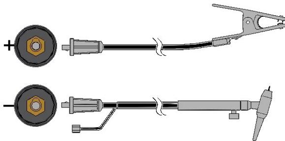
Подключите горелку к терминалу (-), а кабель на деталь подключите к терминалу (+), расположенных на аппарате. Вставьте сварочный разъем, выровняв его так, чтобы выступ ключа входил в ответный паз и поверните его на  $\frac{1}{4}$  оборота по часовой стрелке. В заключение подготовки присоедините газовый шланг к регулятору на баллоне Аргоном.
