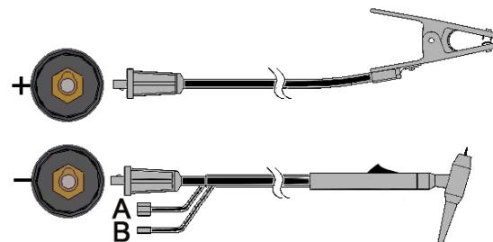
Подключите кабель горелки к терминалу (-), а зажим заготовки - к терминалу (+). Вставьте соединитель с ключом, выровняв его так, чтобы выступ ключа входил в ответный паз, и поверните его на  $\frac{1}{4}$  оборота по часовой стрелке. Не затягивайте слишком сильно.
