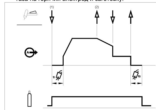
Как показано выше, можно нажать и удерживать курок ТИГ-горелки второй раз во время понижения тока, чтобы завершить функцию понижения и поддерживать ток сварки при токе кратера. При отпускании курка ТИГ-горелки происходит прекращение подачи сварочного тока и начинается заключительная подача защитного газа. Данная рабочая последовательность (2-шаговая без возможности повторного включения) является заводской установкой.
