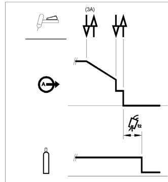
Данная рабочая последовательность (4-шаговая без функции повторного включения) является заводской установкой.
