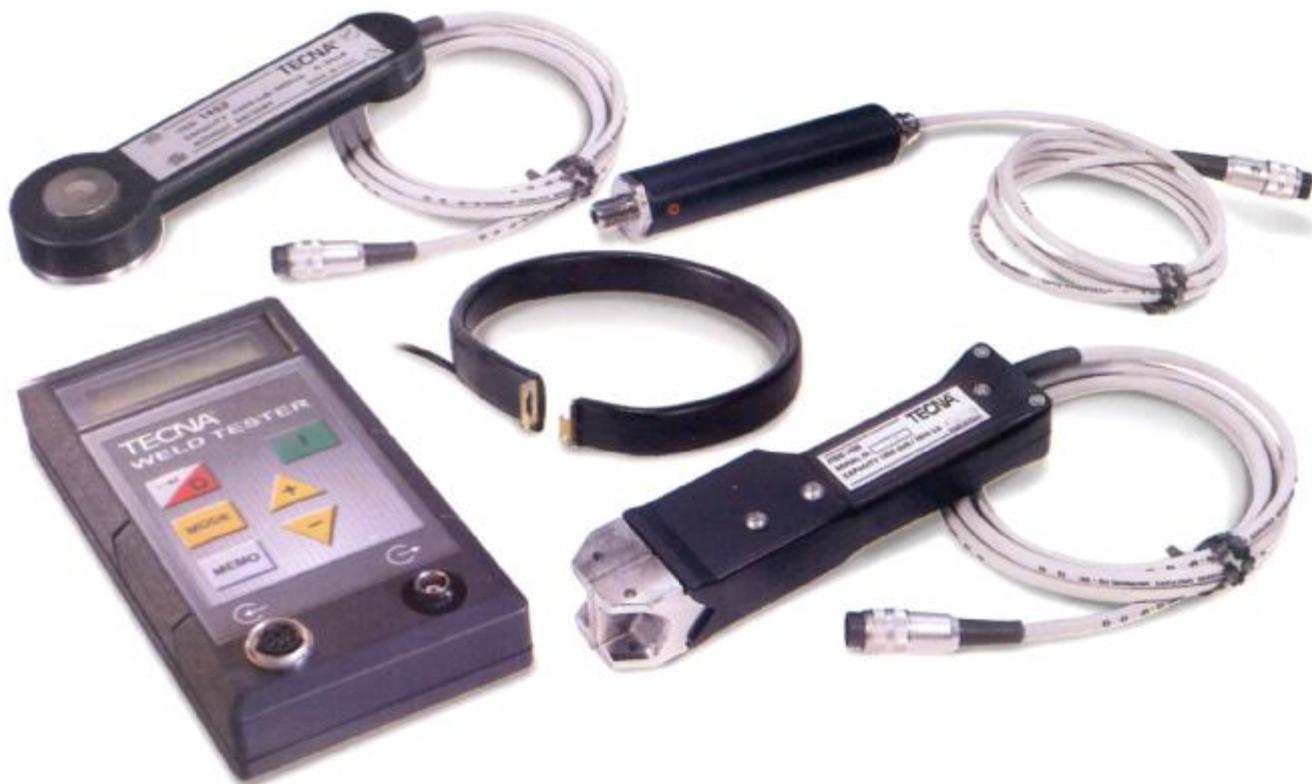
Модель WELD TESTER TE1600 представляет собой портативный инструмент для измерения параметров контактной сварки. при помощи различного рода датчиков один и тот же инструмент позволяет измерять как сварочный ток, так и усилие на электродах. Мощность 32-битного микропроцессора в сочетании с точностью 12-битного аналого-цифрового преобразователя делают этот инструмент отличным высокопроизводительным помощником сварщика.
