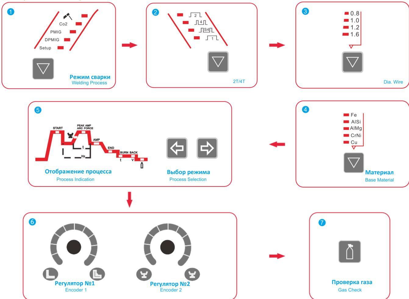
1. Нажмите кнопку **<Welding Process>** (режим сварки) и выберите сварку **<PMIG>**.
