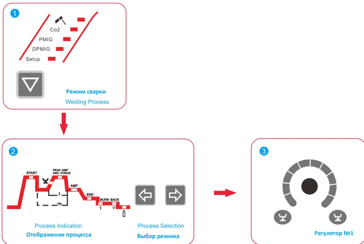
1. Нажмите кнопку **<Welding Process>** (режим сварки) и выберите сварку MMA.
