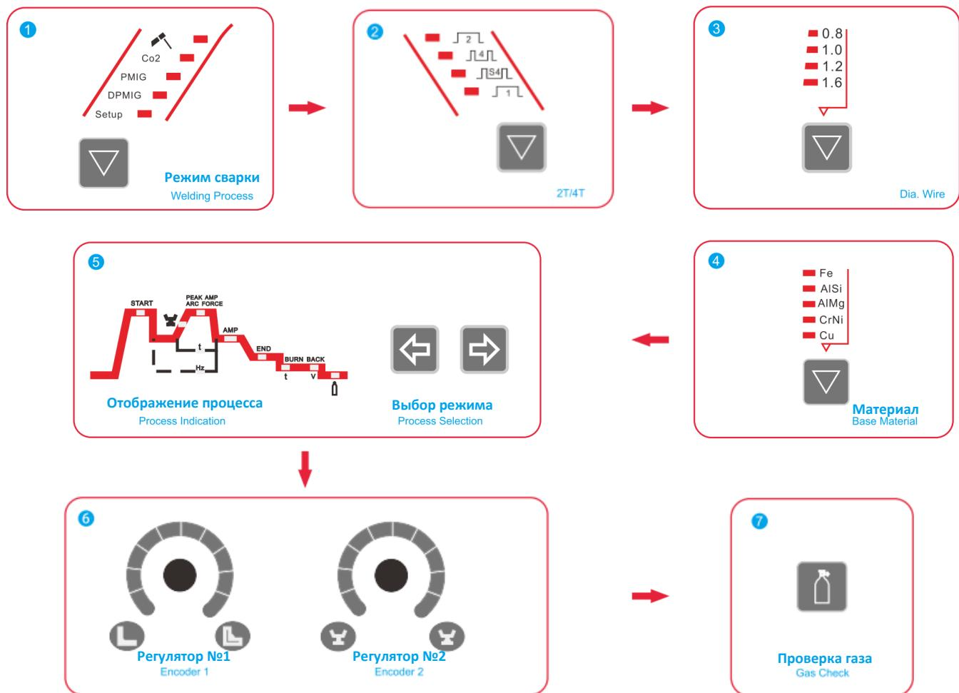
1. Нажмите кнопку **<Welding Process>** (режим сварки) и выберите сварку **<DPMIG>**.
