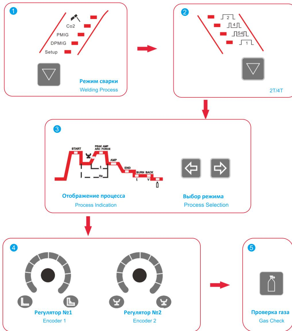
1. Нажмите кнопку <Welding Process> (режим сварки) и выберите сварку <CO<sub>2</sub>>.
