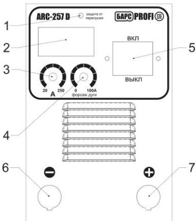
1. Сигнальная лампа 1 (загорается при срабатывании защиты от перегрузки)
