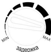
Позволяет увеличить время просветления после окончания сварки. Это особенно удобно для защиты глаз от «послесвечения» горячего металла/шлака после сварки на больших токах. Можно выставить короткую задержку MIN (0.1 сек) или длинную MAX (1.0 сек).
