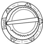
Позволяет настраивать степень затемнения в зависимости от светового излучения дуги. Большая затемненность предназначена для большей яркости дуги (для настройки смотри таблицу 2, стр.14).
