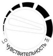
Позволяет настраивать наиболее комфортное время срабатывания светофильтра в зависимости от типа сварки, условий внешнего освещения, степени остаточного свечения сварного шва после сварки.
