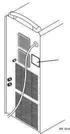
Убедитесь в том, что блок подключен к сети электропитания с требуемым напряжением и защищен предохранителями требуемого номинала. Необходимо обеспечить защитное заземление в соответствии с действующими нормами.
