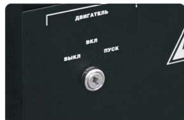
(c) Установите выключатель в положение «ВЫКЛ».
