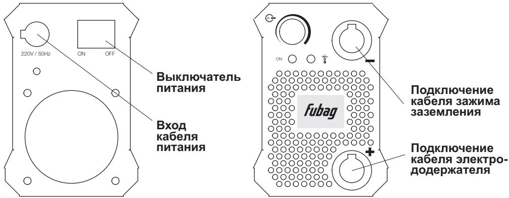
**Подключение кабелей электрододержателя и зажима заземления.**
