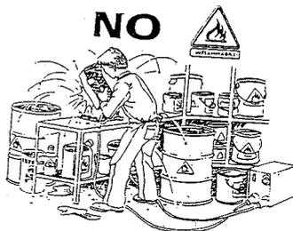
Перед началом сварки проветрить помещение с потенциально горючей средой. Не работать в среде с большой концентрацией пыли, горючих газов и паров.
