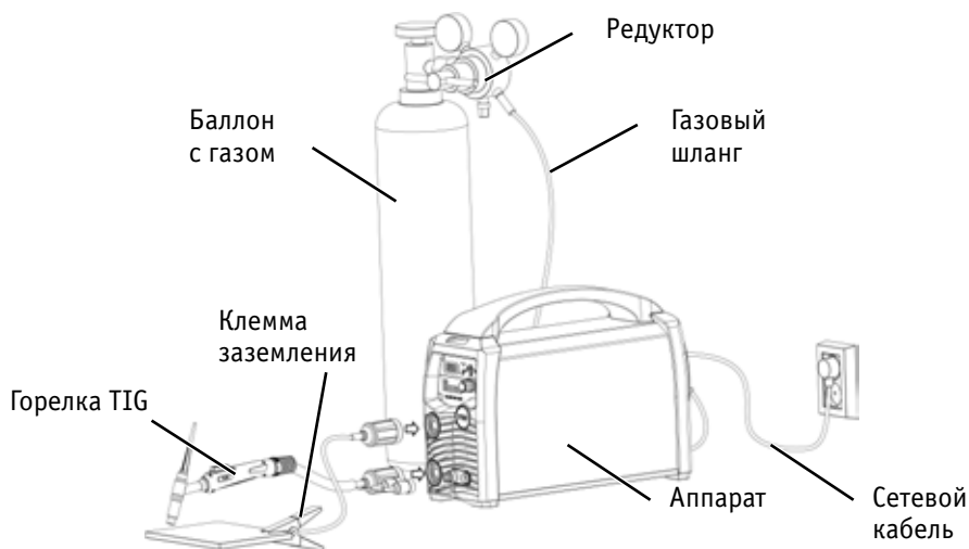
Рис. 8.1. Схема подключения оборудования.
