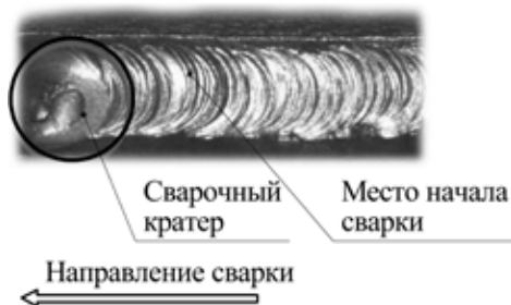
Рис. 10.4. Начало сварки при смене электрода.
