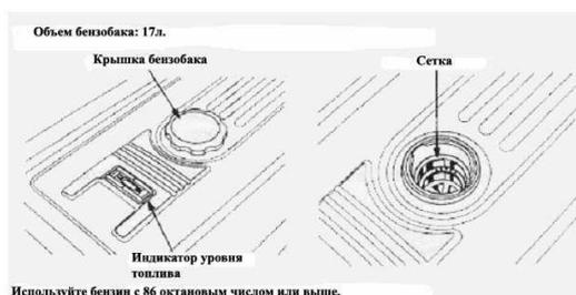
Для смеси бензин-масло, мы рекомендуем использовать неэтилированный бензин, потому что меньше оставляет отложений на свече зажигания и увеличивает срок службы системы вывода выхлопных газов
