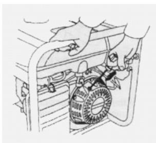
Топливный клапан находится между топливным баком и карбюратором. Когда рычаг клапана находится в позиции ВКЛ, топливо беспрепятственно поступает от бензобака в карбюратор. Не забудьте поместить рычаг в положение ВЫКЛ после завершения работы
