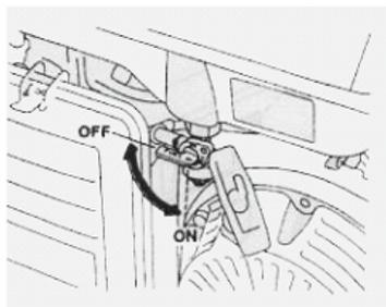
Дроссель предназначен для обогащения горючей смеси при пуске холодного двигателя. Управление дросселем может производиться вручную. Потяните рычаг дроссельной заслонки в сторону положения ЗАКРЫТО, чтобы обогатить смесь
