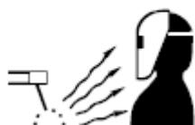
Используйте защитную маску с соответствующим фильтром и накладками для защиты лица и глаз от искр и лучей сварочной дуги. Маска и линзы должны соответствовать требованиям стандартов безопасности.
